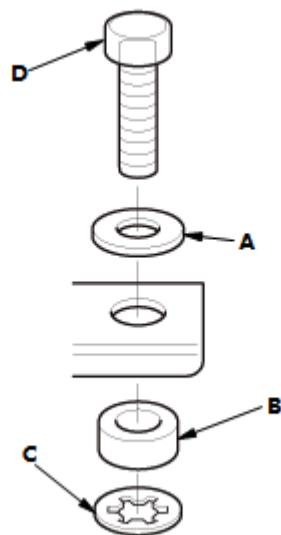
后侧下锚定器螺栓安装
